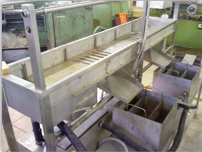
Опытная установка Alexpulse HO-180 АО «НИКИЭТ» г. Москва
